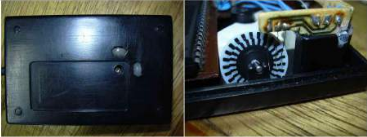
Figura 10.41: Como Funcionava o TPX Mouse Fonte: tabalabs.com.br
