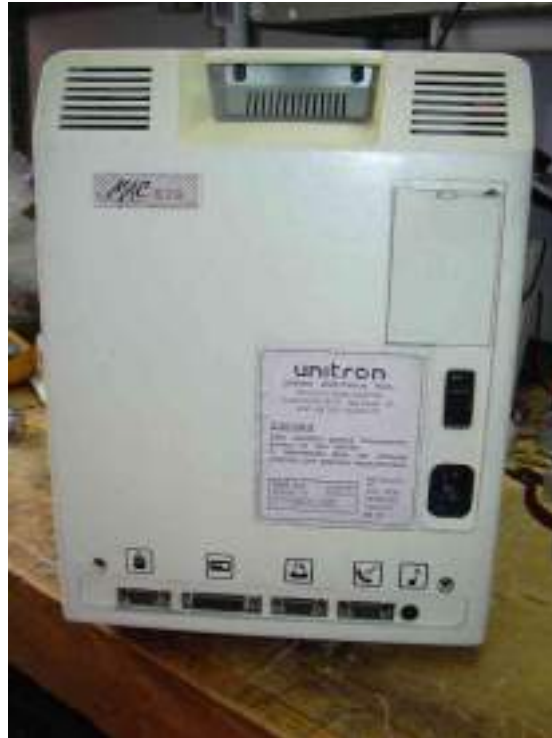
Figura 14.2: Traseira do Unitron Mac 512 com os conectores de mouse, drive externo, impressora, modem e saída de áudio. Fonte: Tabajara Labs (Alexandre Souza)
