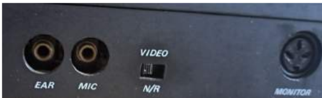
Figura 7.17: Switch de inversão de vídeo, letras brancas fundo preto ou vice-versa, na parte traseira do gabinete. Fonte: Acervo do Autor
