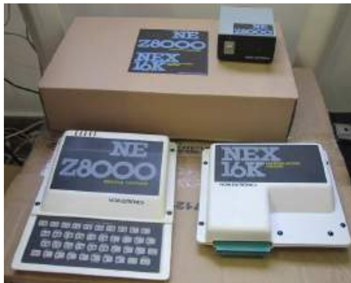
Figura 7.14: NE Z 8000 e o modulo NEX 16 KB de expansão de memória. Fonte: Acervo do Autor
