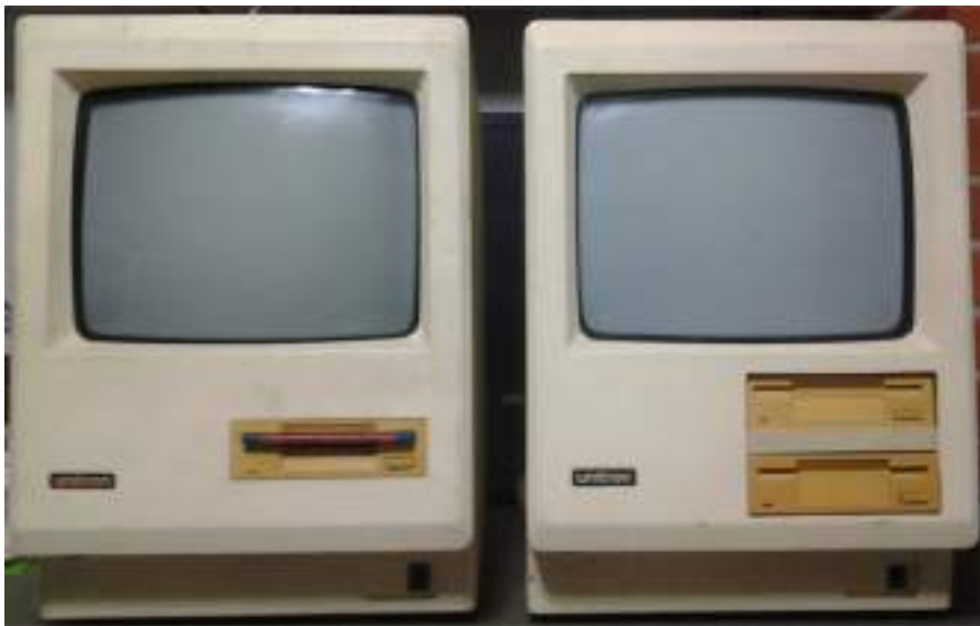
Figura 14.1: Unitron Mac 512 de 1 e 2 drives de 3 1/2 e conector do teclado no canto inferior direito frontal. Fonte: Marcio Velasco Museu de tecnologia
