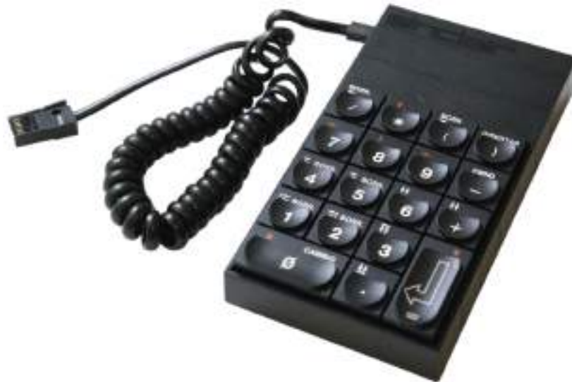
Figura 9.5: Sinclair ZX Spectrum 128 keypad externo Fonte: Wikimedia Commons
