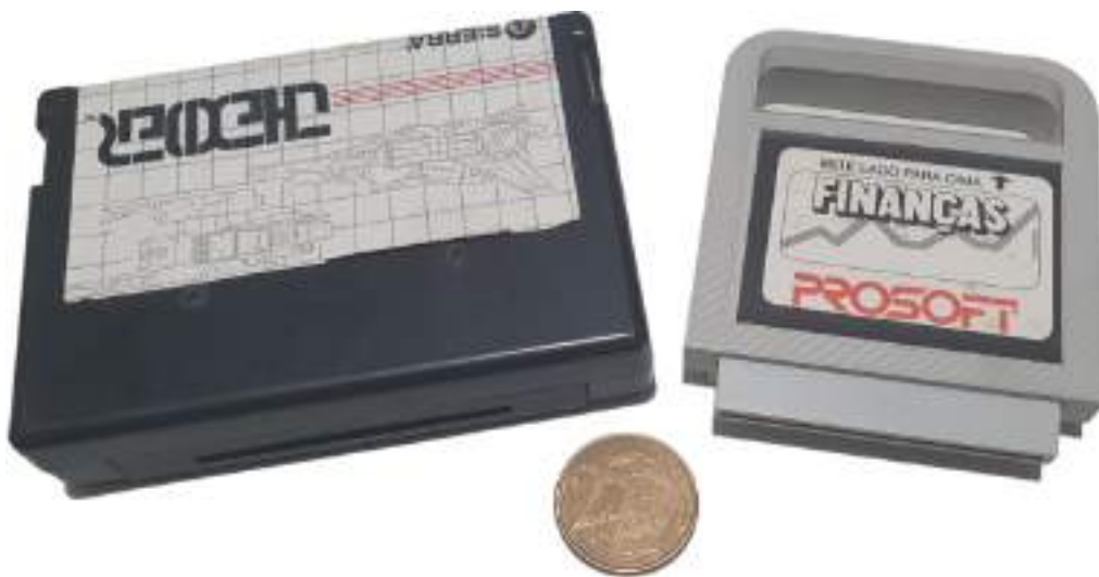
Figura 8.17: Comparação Cartucho padrão Tandy e Cartucho do CP 400 Prologica Fonte: Acervo do autor
