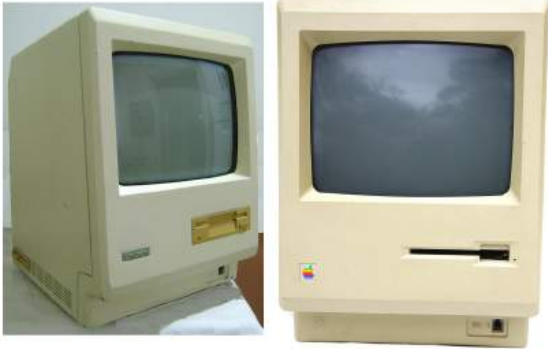
Figura 14.4: Unitron Mac 512 x Apple Macintosh 512. O Mac da Apple não possuía botão físico, o eject do disco era por software e não era raro dar defeito no mecanismo, o da Unitron era um drive comum de 31/2 da Chinon. Fonte: Evolução Tecnológica e Wikimedia Commons
