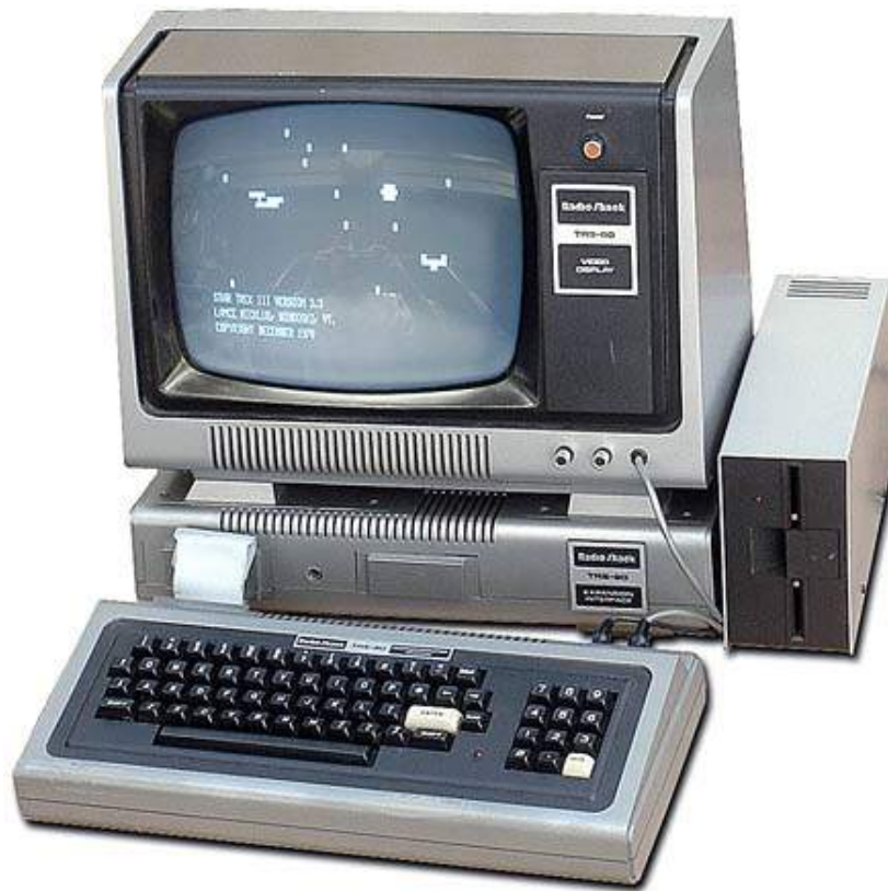
Figura 6.4: Módulo Interface de Expansão do TRS-80 Model I Fonte: Old Computers
