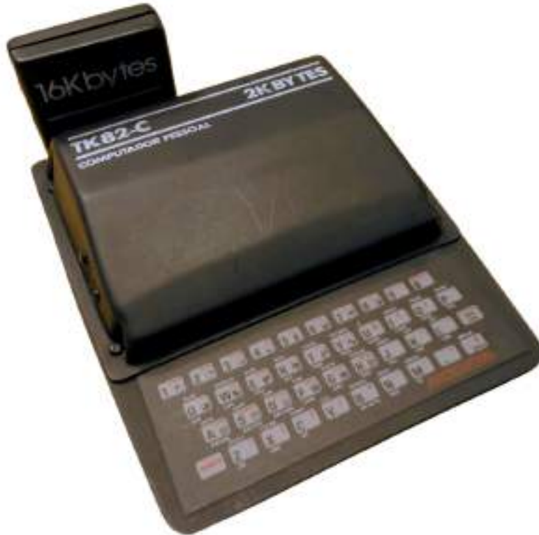
Figura 7.4: Microdigital TK 82C com a expansão de 16 KB Fonte: Wikimedia Commons
