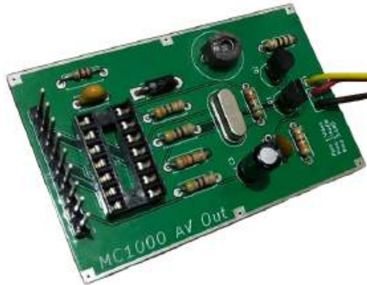
Figura 13.10: Placa para melhorar a saída de áudio e vídeo do MC 1000 Fonte: Lisias Toledo
