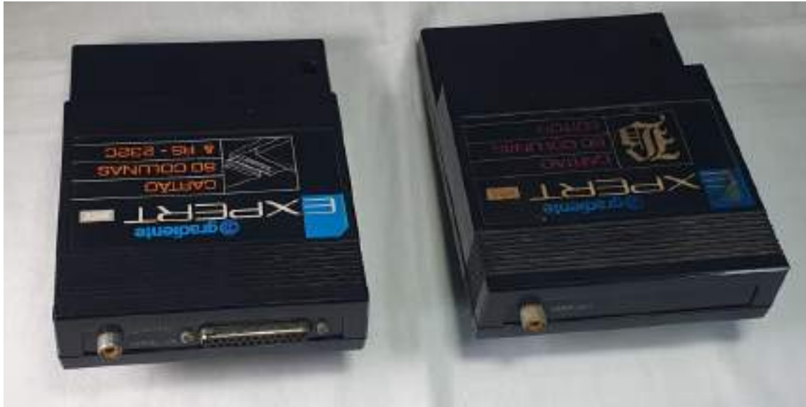
Figura 10.25: Os cartões de 80 colunas Gradiante CT-80E e CT-80NET Fonte: Acervo do autor
