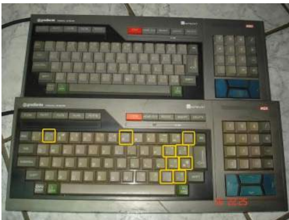
Figura 10.16: Diferenças do teclado do XP-800 antes e depois do recall Fonte:MSX.org
