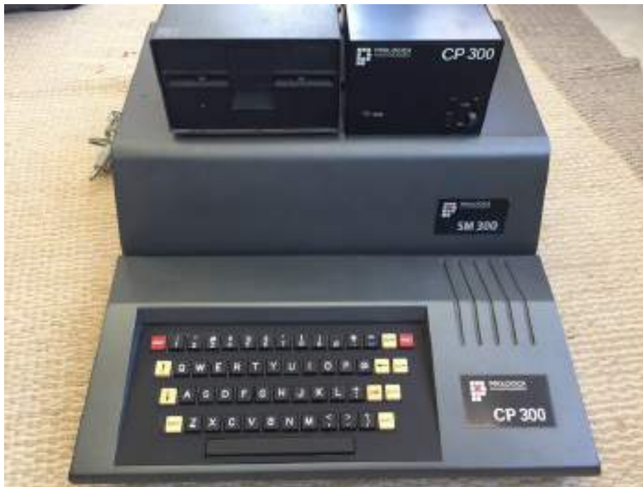
Figura 6.26: CP300 e sua fonte externa com a interface de drive SM 300 e 1 drive de disquete Fonte: Datassete
