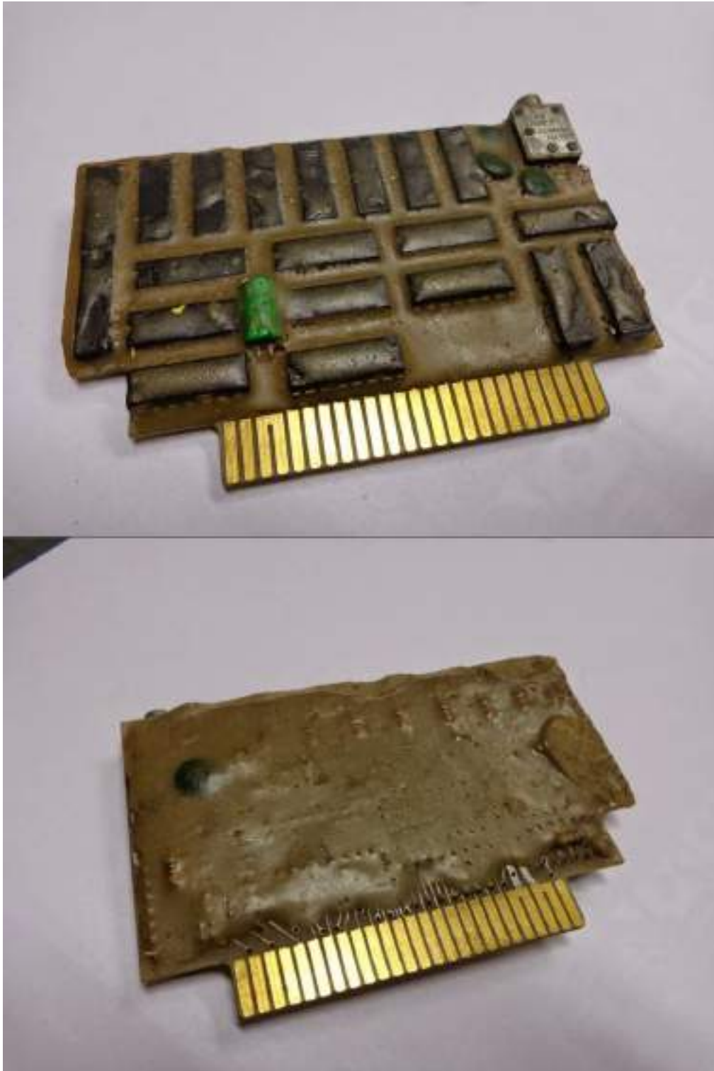
Figura 10.42: Fotos da ACVS MegaRAM de 256 KB, a primeira MegaRAM produzida pelo Ademir Carchano em 1987 Fonte: Ademir Carchano
