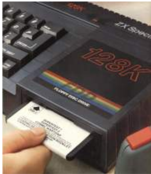
Figura 9.9: Drive de 3 polegadas do Spectrum +3 Fonte: Sinclair Users n o 68
