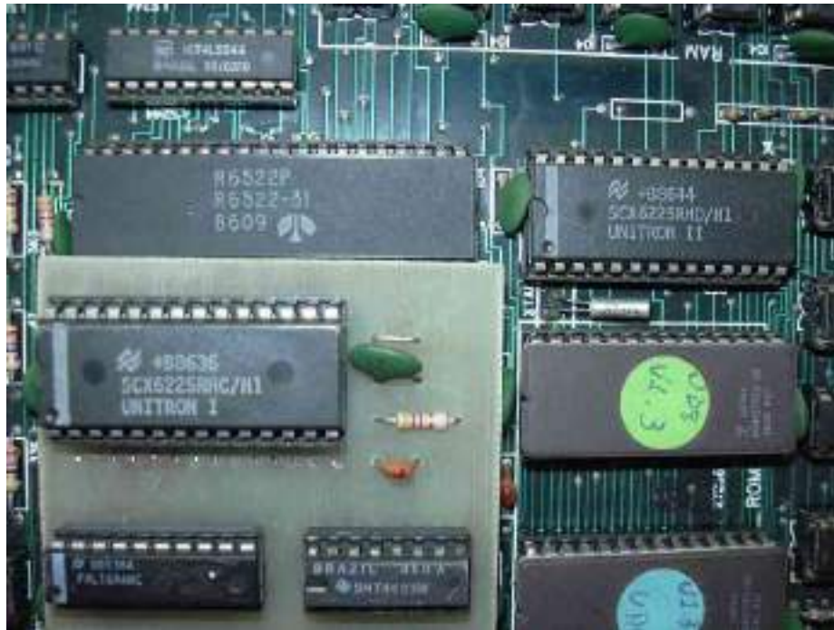
Figura 14.7: Interessante notar os integrados Unitron I e Unitron II, fabricados pela National Semiconductors. Fonte: Fonte: Tabajara Labs Alexandre Souza
