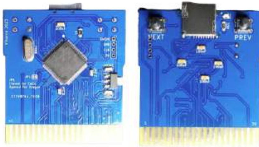
Figura 8.25: Emulador de interface, Drive e Cartuchos para TRS CoCo Fonte: Victor Trucco
