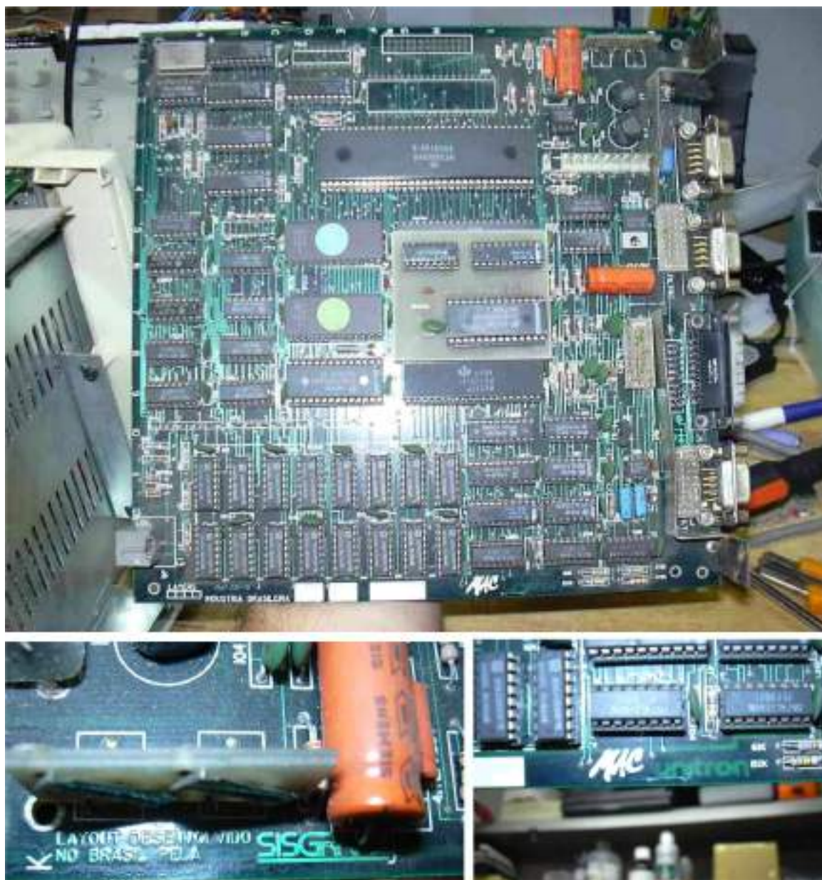
Figura 14.6: Placa l3gica de 4 camadas produzida pela Sisgraph, com detalhes para a grafia do "Mac" igual ao da apple, e o logo da Unitron numa das camadas internas da placa. Observe que o layout tem 3 mais parecido com o Mac Plus de 1986 do que com o Mac 128/512 de 1984 Fonte: Tabajara Labs (Alexandre Souza)
