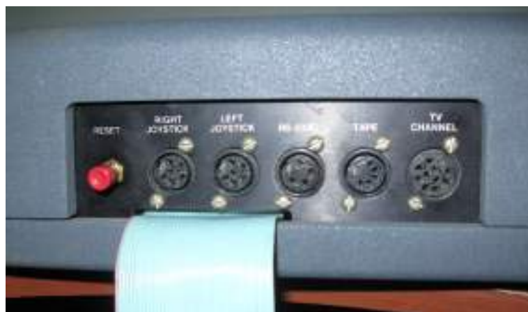
Figura 8.10: Conectores traseiros do Novo Tempo/LZ Color 64 Fonte: AMX Project
