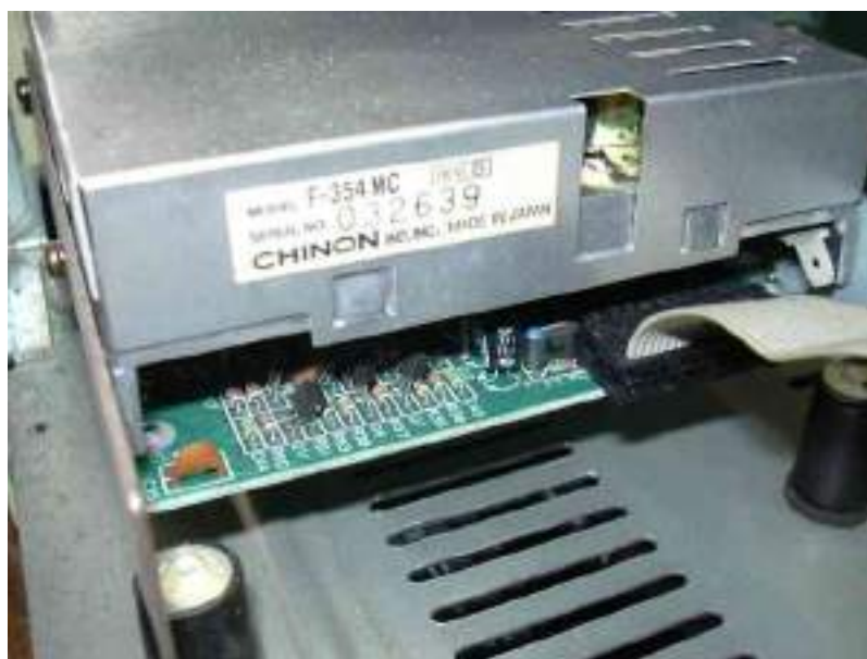
Figura 14.8: Drive japonês Chinon. A Elebra ainda não fabricava drives de 3 1/2 nessa época. Fonte: Fonte: Tabajara Labs Alexandre Souza
