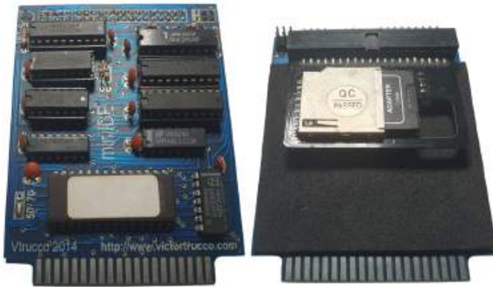
Figura 8.26: Interface IDE utilizando um adaptador IDE->Cartão SD Fonte: Victor Trucco
