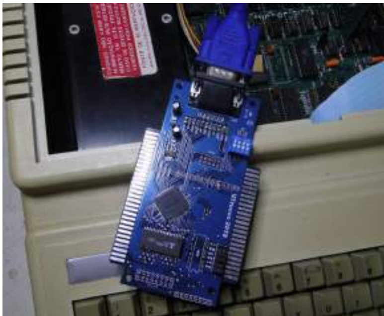
Figura 5.39: Placa VGA para Apple II, II+, IIe, IIc e clones Fonte: Victor Trucco
