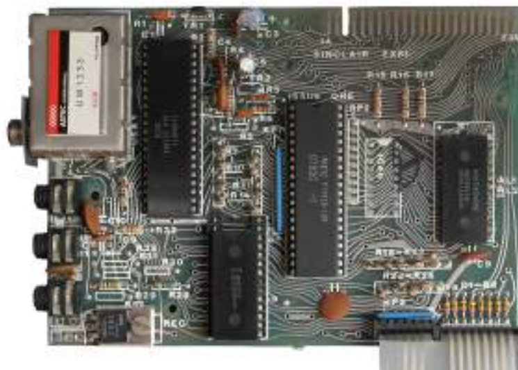
Figura 7.3: Placa mãe do Sinclair/Timex ZX-81 Fonte: Wikimedia Commons
