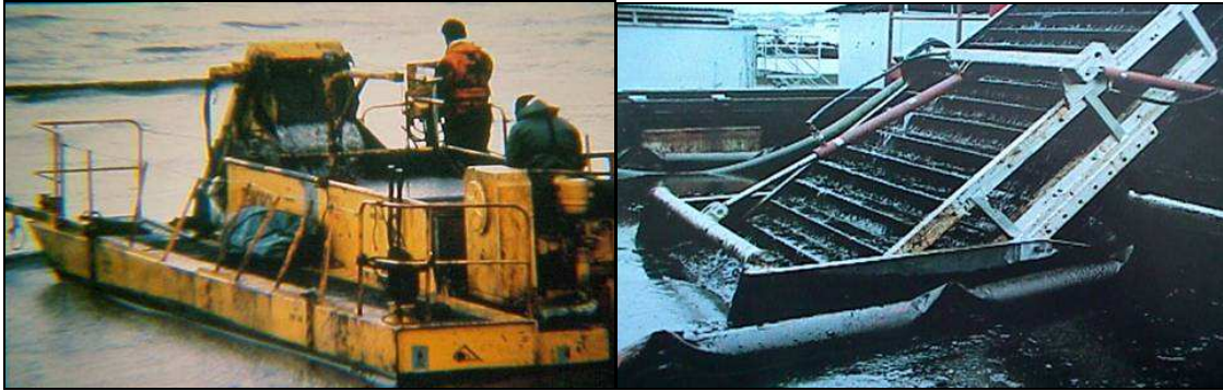
Figura 10: Recolhedores de óleo do tipo mecânico – Egmopol.
