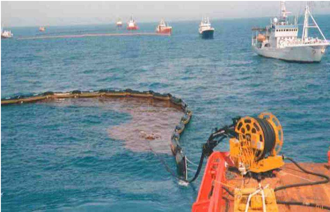
Figura 5: Contenção e recuperação de óleo – Stavanger - Noruega 2005.
