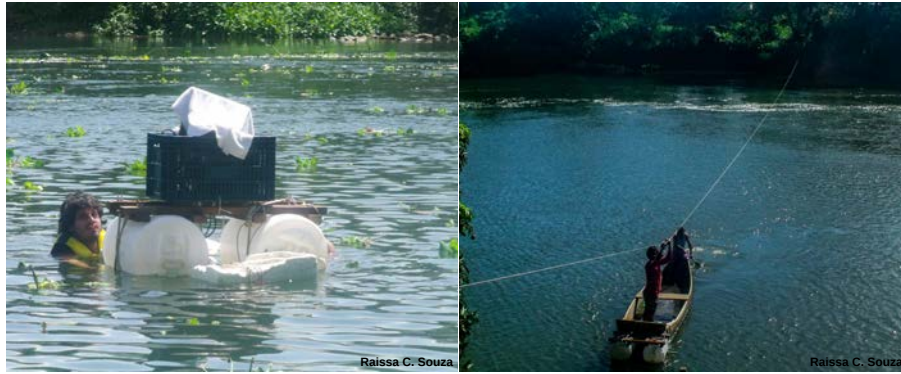
Figura 4.24: Campanhas de medição de vazão com ADCP. Medição utilizando apenas a balsa Papillon (foto à esquerda) e medição utilizando uma canoa apoiando a balsa Papillon (foto à direita).
