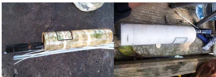
Figura 7.19: Sonda RBR Duo após 7 dias de monitoramento na estação 9 (esquerda) e após a limpeza (direita).
