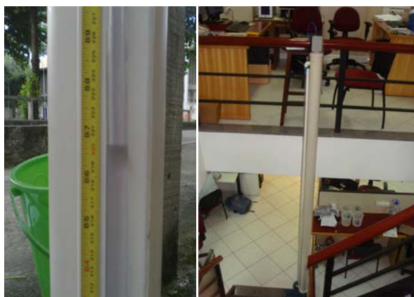
Figura 4.7: Coluna d'água graduada para simulação da variação de nível da água para teste do sensor de pressão da sonda RBR Duo: a foto da esquerda mostrando a leitura do nível e a foto da direita mostrando o aparato completo.
