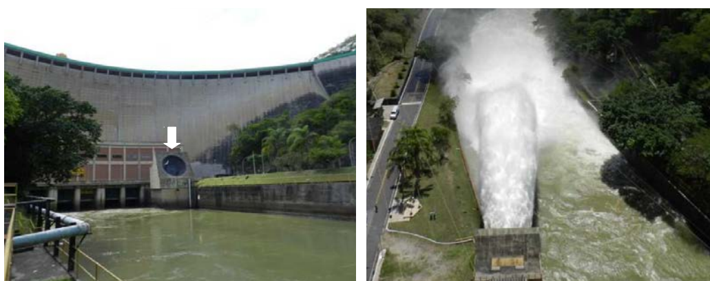
Figura 5.32: Teste da válvula difusora na UHE Funil em 18/11/14 durante 3 horas (11:00 - 14:00). Seta branca apontado a saída do difusor. Foto tirada por Marcelo Roberto Rocha de Carvalho.
