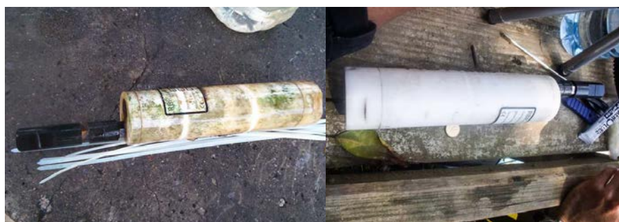
Figura 4.18: Sonda RBR Duo após 7 dias de monitoramento na estação 9 (esquerda) e após a limpeza (direita).
