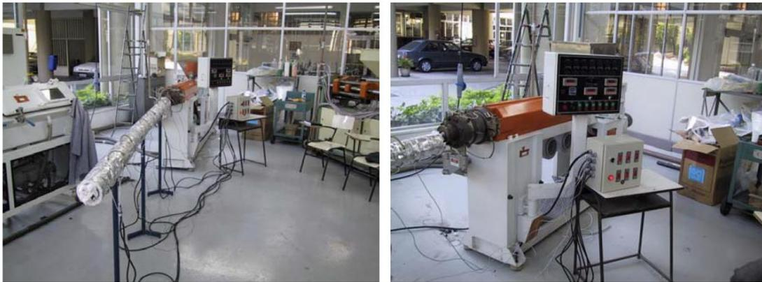
Figura 2-31: Aparato para injeção de polipropileno [47].
