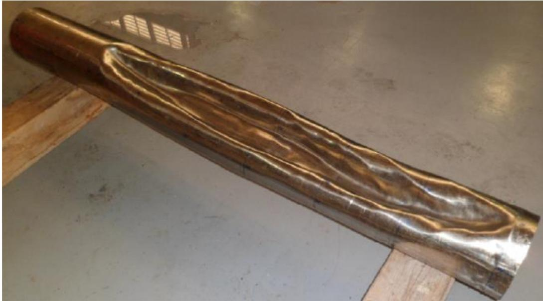
Figura 2-36: Duto sanduíche com anular de compósito à base de cimento reforçado com fibras de PVA depois do ensaio de pressurização externa [59].
