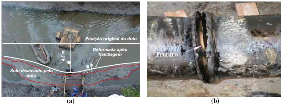
Figura 2-22: Detalhes do acidente com o duto PE-2 [41]: (a) Deslocamento lateral pós flambagem (4,5 m) e (b) Detalhe na falha do duto PE-2.
