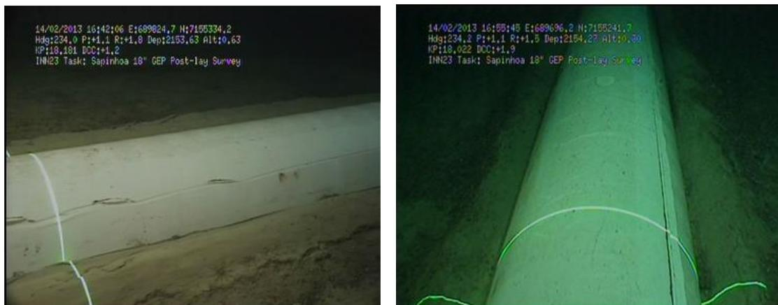
Figura 2-13: Inspeção à laser de dutos rígidos por ROV.
