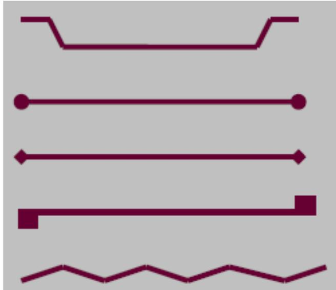
Figura 2-41: Formato das fibras de aço [75].
