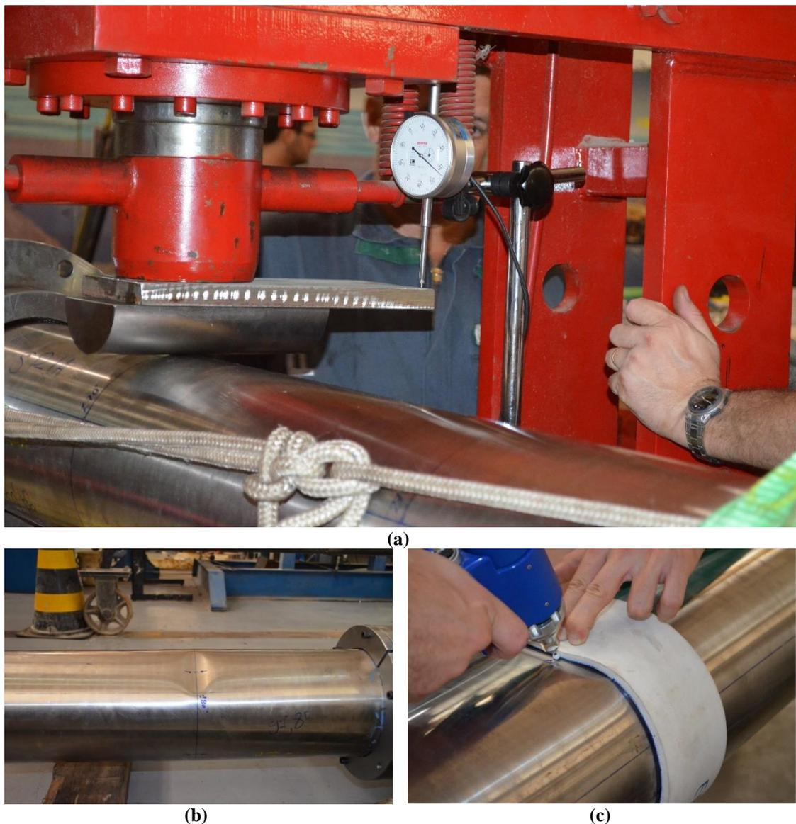
Figura 3-21: (a) Prensa hidráulica utilizada para realizar o dano na superfície do protótipo, (b) Dano na superfície do protótipo e (c) Mapeamento da imperfeição causada pelo dano.
