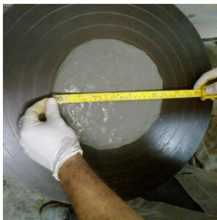
Figura 3-7: Ensaio de espalhamento do compósito.
