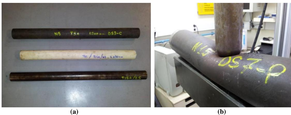
Figura 2-37: (a) Detalhe das camadas do duto sanduíche com anular de PVDF e (b) Realização do dano controlado na estrutura [61].
