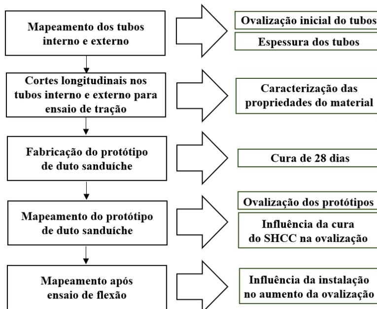
Figura 3-4: Fluxograma da obtenção de parâmetros nas três etapas de mapeamento.
