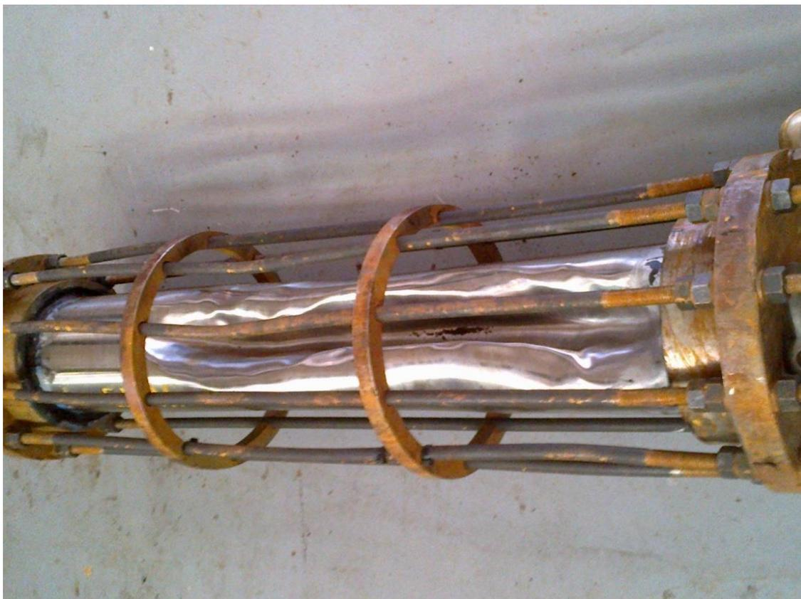
Figura 3-19: Configuração do teste de colapso com a presença de hastes no protótipo DS-A1-a.
