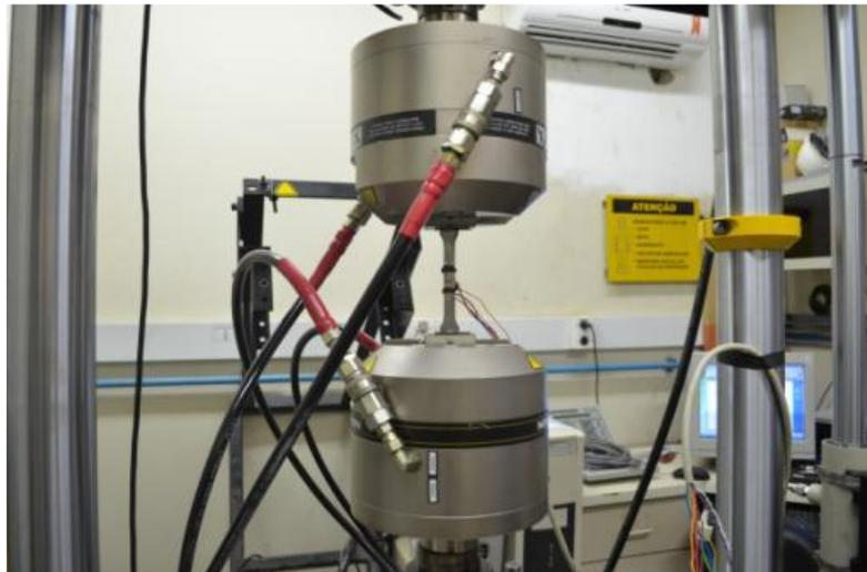
Figura A-14: *Set-up* do ensaio experimental no aço inoxidável.
