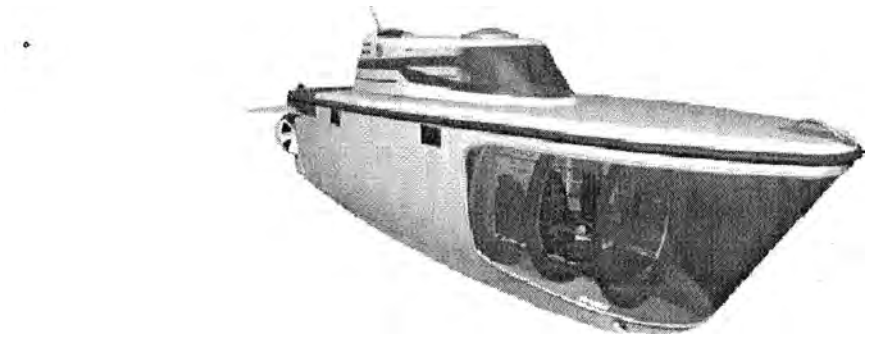
Figura 26 – Discovery -submersível de turismo com casco em GRP, profundidade de 300m (Small Submarines & Submersibles. U. S. Submarines Inc., 2002)
