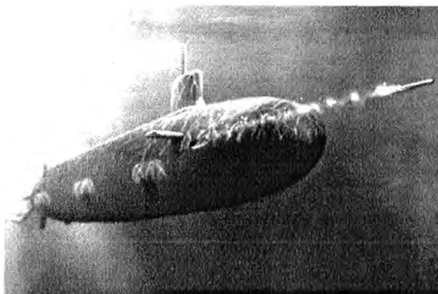
Figura 51 - X-1 movido a diesel e peróxido de hidrogênio ( http://www.submarine-history.com/NOVAfour.htm , ac.:21/02/05) abandonado pela instabilidade da combinação Peróxido e Diesel.
