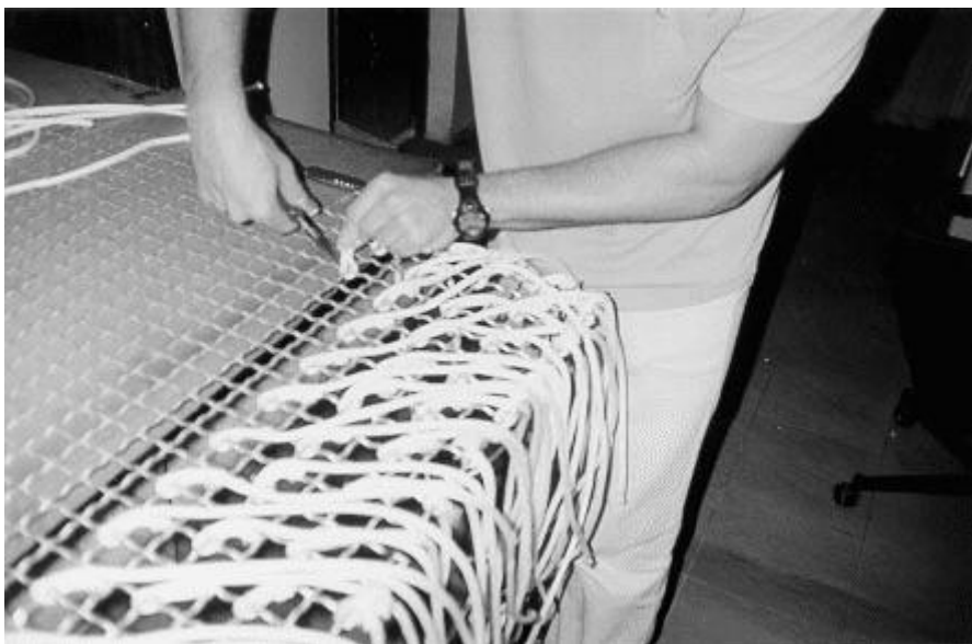
Figura 4.9 – Preparação para experimentos com campo de hastes através da montagem das telas de 1,00 x 0,75 m com hastes de 0,6 m.
