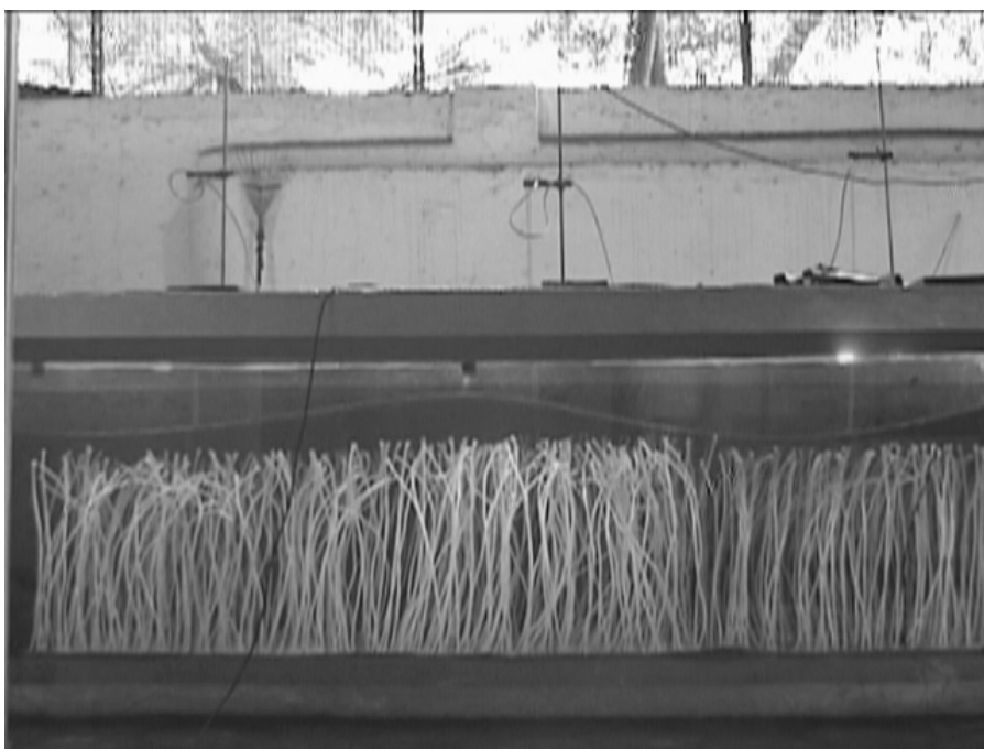
Figura 4.10 - Testes preliminares no canal de ondas com o campo artificial.
