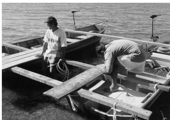
Figura A.4 - Esquema de montagem do catamarã para lançamento da gaiola externa.
