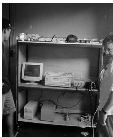
Figura A.8 - Estação base situada na margem do reservatório com sistema de aquisição de dados.
