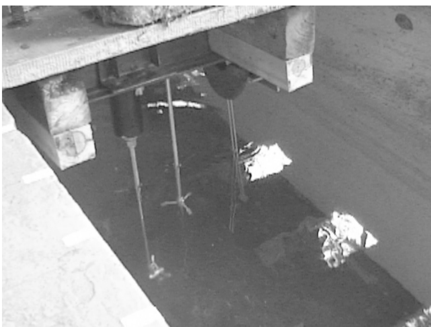
Figura 4.22 – Detalhe do ponto de medição P5, com duas sondas de velocidade a esquerda e a sonda de nível a direita.
