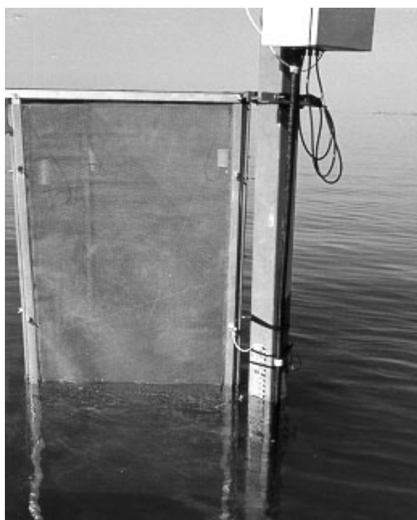
Figura A.6 - Estado final da torre externa, com o cabo chegando na caixa de passagem para alimentação da iluminação noturna e das sondas. O esquema mostra a posição do zero dos sensores coincidindo com o nível d'água.
