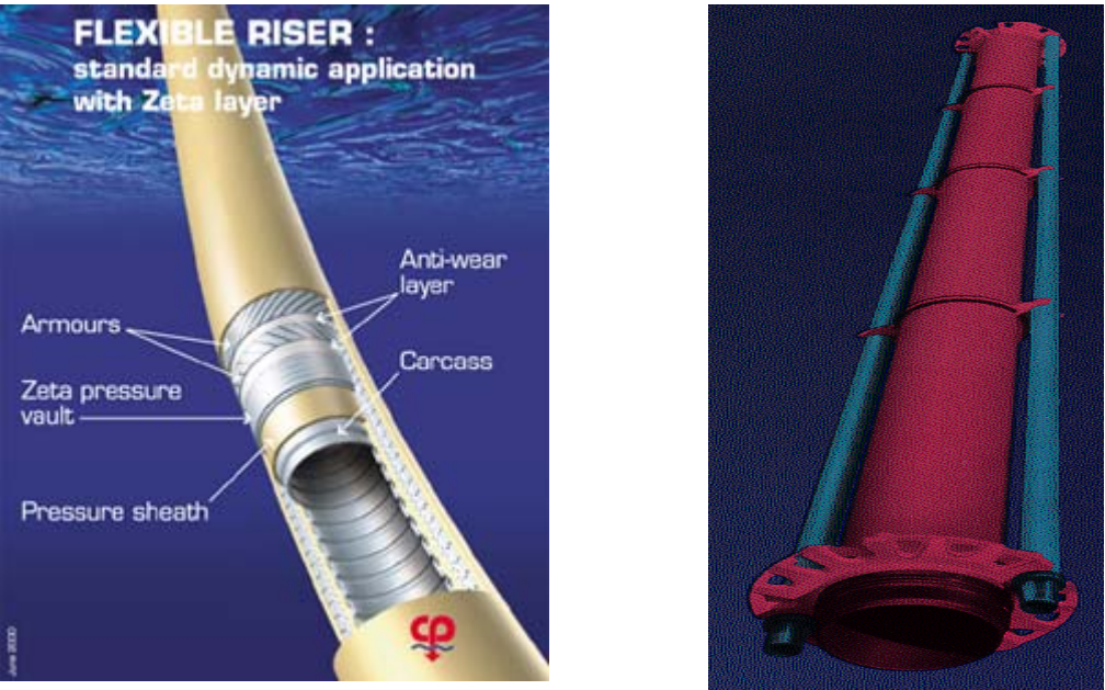
Figura 6 – “Riser” Flexível / “Riser” Rígido de perfuração
