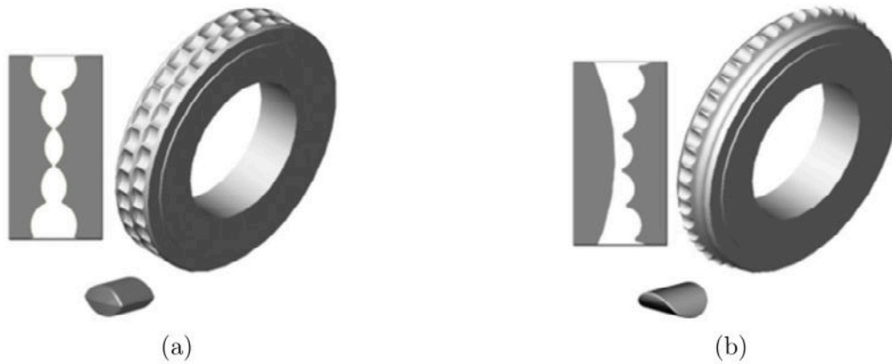
Figura 3.4: Exemplos de rolos formadores de prensa de rolos para produção de briquetes em forma de gota ou travesseiro (a) e em forma de sela (b) [28].
