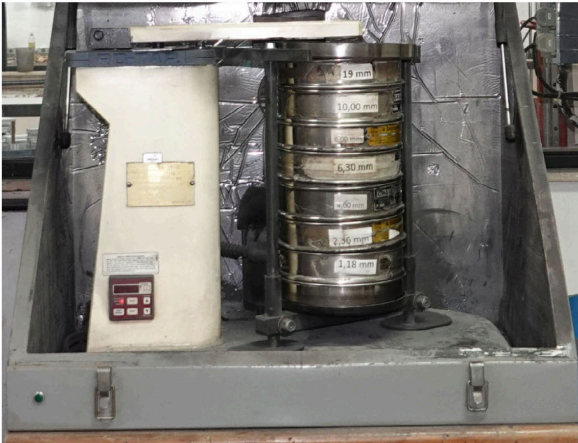
Figura 4.5: Equipamento de agitação automático montado com série de peneiras.
