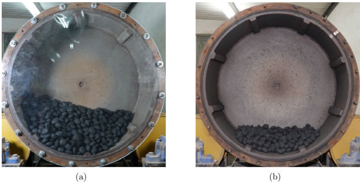
Figura 5.21: Tambor preparado para o início do ensaio (a) e carregado após 30 min, preparado para o último intervalo de observação (b).
