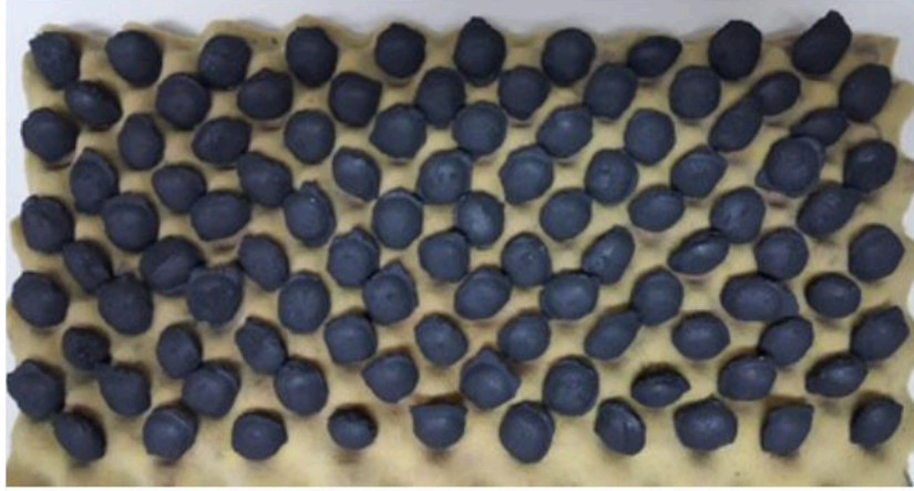
Figura 4.3: 100 briquetes selecionados de uma amostra para a realização do ensaio de queda individual.
