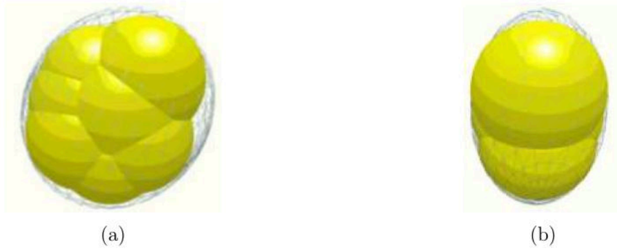
Figura 4.8: Imagens do modelo da partícula de briquete no EDEM, composta por sete esferas superpostas, em vistas superior (a) e lateral (b) [57].
