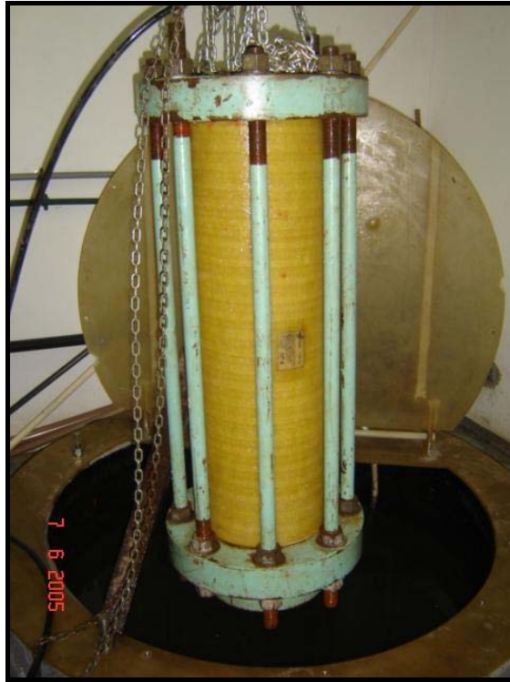
Figura 35: Tubo engastado por flanges e o poço.
