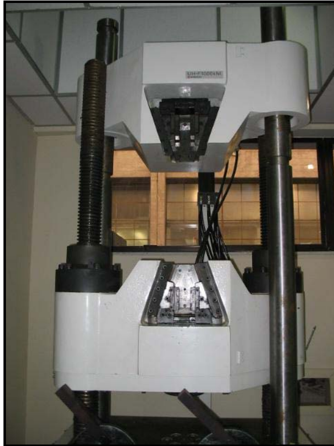
Figura 30: Prensa para o ensaio de tração.
