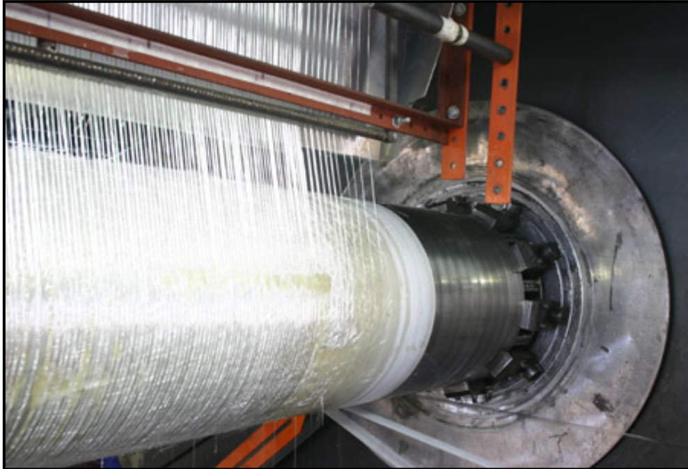
Figura 6: Equipamento de enrolamento filamental (“filament winding”). Fonte: disponível em http://www.polyplaster.com.br .
