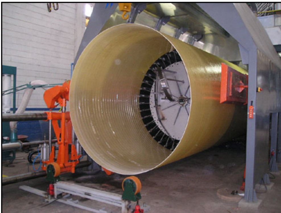
Figura 7: Processo de cura e remoção do mandril.
