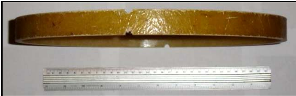
Figura 26: Vistas do anel obtido a partir do corte dos tubos.
