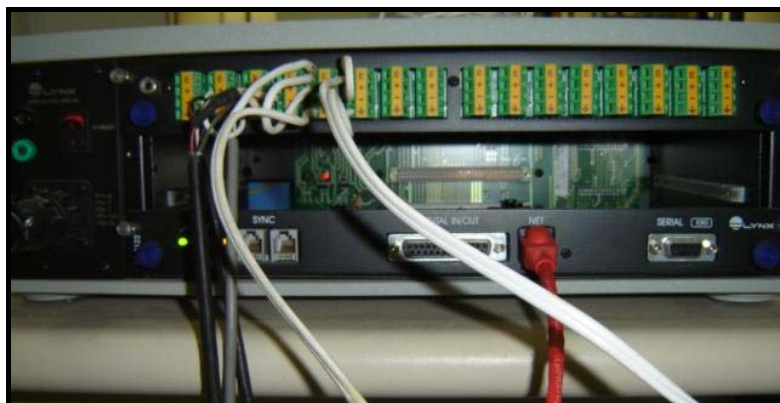
Figura 31: Condicionador de aquisição de dados dos extensômetros.
