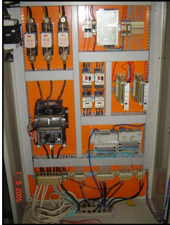
Figura 34: CLP do equipamento para ensaio hidrostático.
