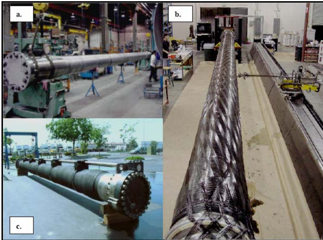
Figura 8: Fabricação de riser por filament winding.
