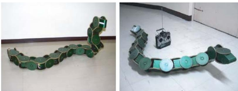
**Figura 4.9** Mecanismo de Corda Ativa (ACM-R3) (HIROSE & FUKUSHIMA, 2002).
