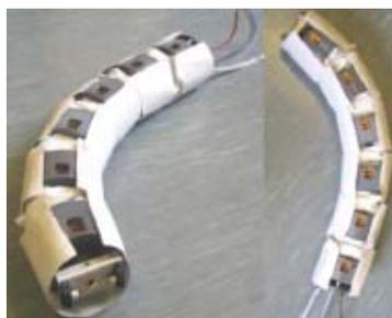
**Figura 4.12** Robô serpente modular com cinco segmentos (LILJEBÄCK & STAVDAHL *et al.*, 2005).
