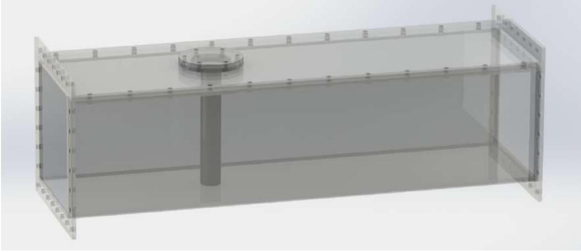
Figura A.2: Modelo da seção de testes quadrada de lado 150 \text{ mm} e comprimento 600 \text{ mm} com um corpo de prova cilíndrico de diâmetro 25,4 \text{ mm} .
