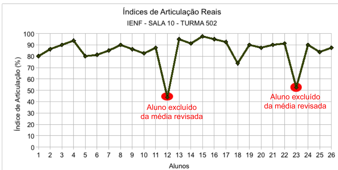
Figura C.12: Variação da inteligibilidade para os testes de articulação reais na sala 10, turma 502 do IENF.
