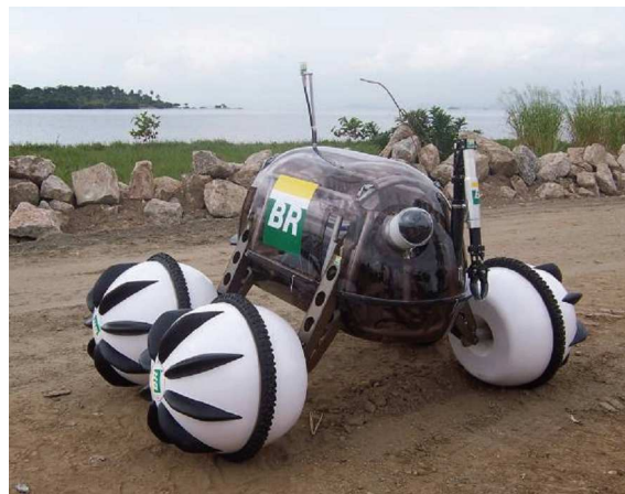
Figura 1.12: Robô Ambiental Híbrido (RAH) desenvolvido para a Petrobras [Fonte: [3]].
