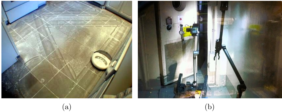
Figura 1.1: Exemplos de robôs da empresa iRobot que operam em ambientes não-estruturados. (a) Robô móvel de uso doméstico Roomba em tarefa de limpeza. (b) Robô PackBot de aplicações especiais, operando na usina nuclear de Fukushima Daiichi - Japão. (Imagens disponíveis na internet).
