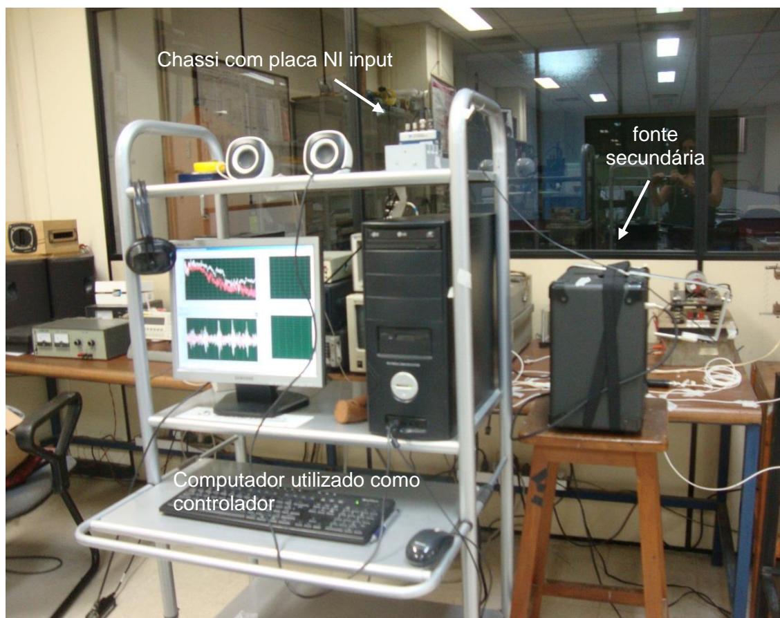
Figura 6.5: computador com LabView instalado, chassi e placa NI 9233 input, fonte secundária e microfone de erro
