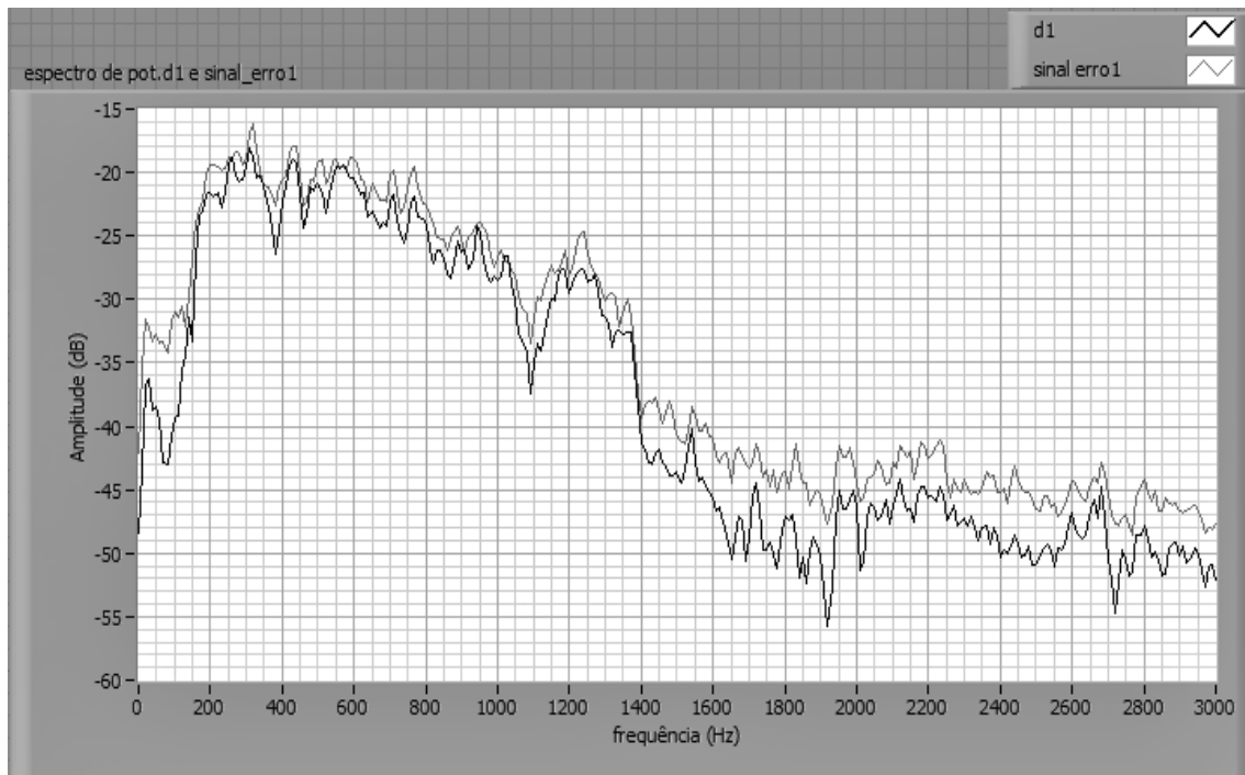
Figura 7.44: espectro do sinal desejado captado no microfone primário, e o sinal de erro resultado da primeira adaptação do filtro.
