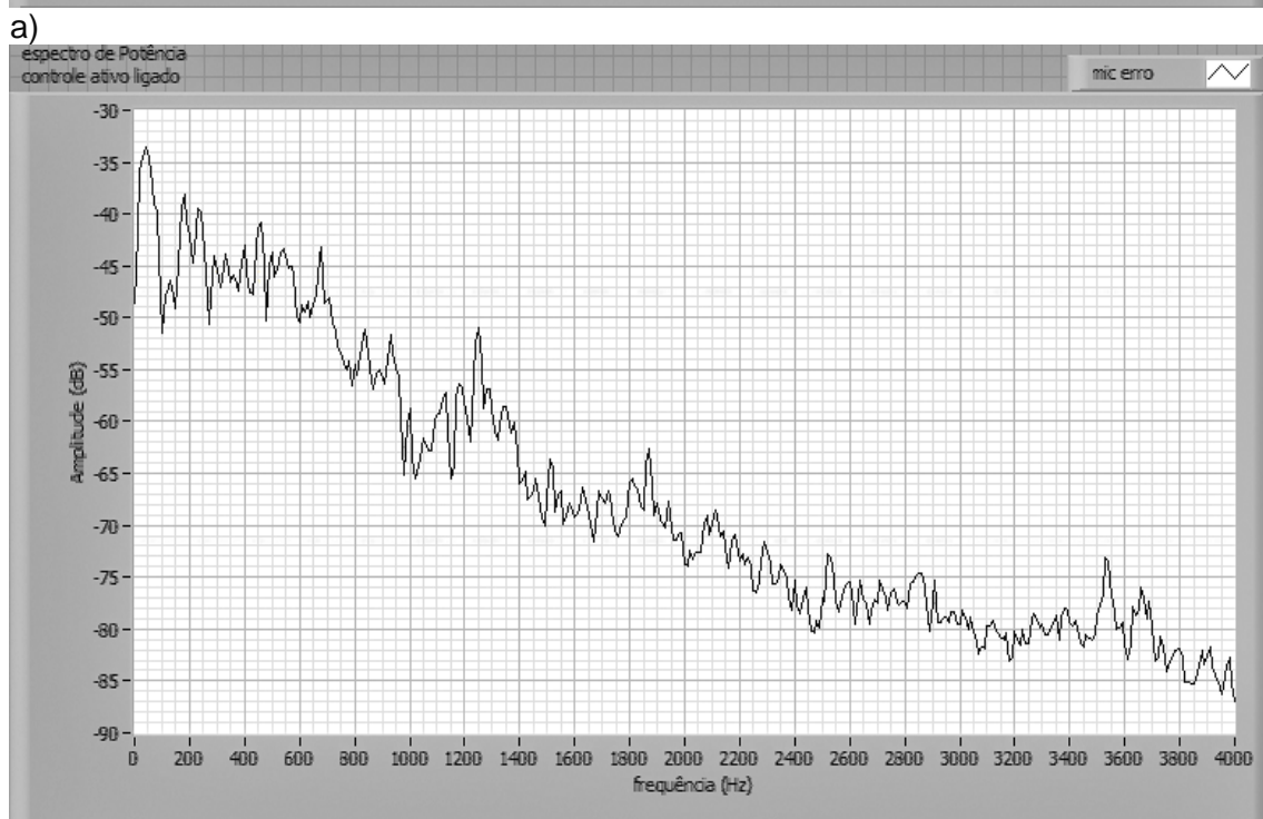
Figura 7.49: primeiro experimento com o ruído de helicóptero, no trecho com ruído Blade Slap e ruído de turbina mais perceptível a) Com controle ativo desligado; b) Com controle ativo ligado por realimentação. N = 250 e \mu = 0,0003
