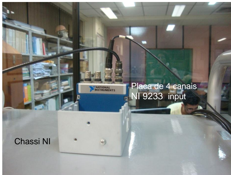
Figura 6.6: chassi NI cDAQ-9174 com placa de 4 canais NI 9233 input.
