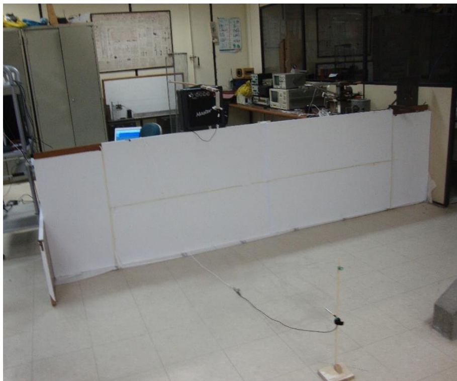
Figura 8.13: microfone de monitoração a 1,2 m de distância da barreira.
