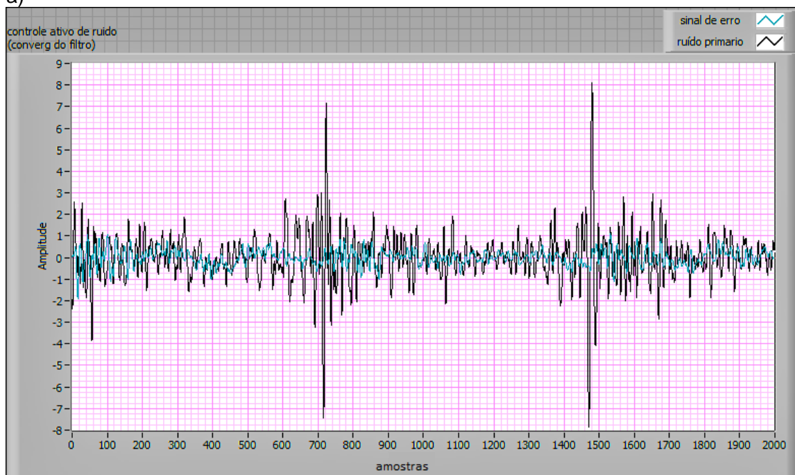
Figura 7.23: convergência do filtro para diversos parâmetros do controle ativo e ruído primário helicóptero, a) \mu = 6 \times 10^{-6} e N = 200 ; b) \mu = 1 \times 10^{-6} e N = 100 .
