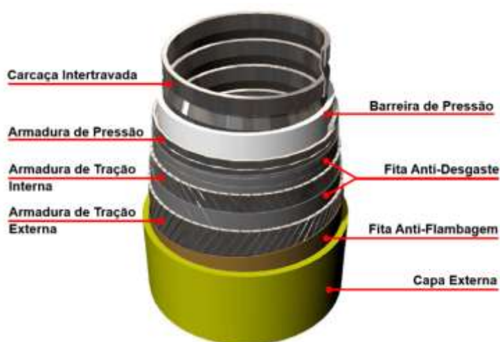
Figura 2-1 – Estrutura típica de um duto flexível (Adaptado de LI et al. [15]).
