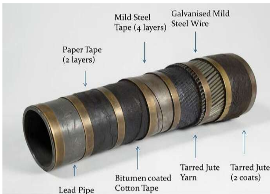
Figura 1-1 – Estrutura do duto HAIS utilizado no projeto PLUTO [2].
